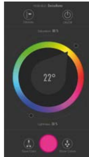
Regler für den Farblauf in %, Helligkeit und Dimmbarkeit von LED-Leisten RGB-ww (farbig & warmweiß)
